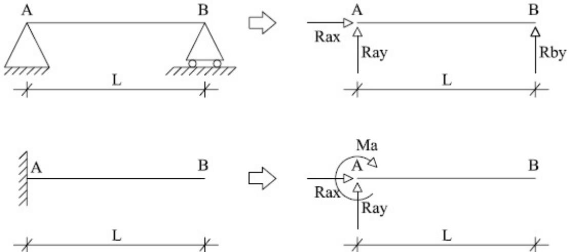
Successivamente per calcolare le reazioni vincolari occorre creare un sistema lineare contenente le equazioni di equilibrio alla traslazione orizzontale ( $\rightarrow$ ), alla traslazione verticale ( $\uparrow$ ) e alla rotazione attorno ad un punto del sistema (tale punto deve essere scelto in modo da semplificare i calcoli).
