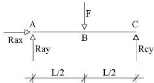
Fase 3: scriviamo il sistema lineare contenente le equazioni di equilibrio alla traslazione orizzontale, alla traslazione verticale e alla rotazione attorno ad un punto del sistema (per la rotazione possiamo scegliere qualunque punto della struttura; in questo esempio sceglieremo il punto A)
