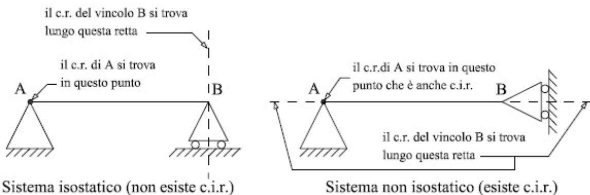
La struttura di un sistema isostatico quando viene sollecitata da una forza si deforma, mentre quella di un sistema non isostatico ruota attorno al c.i.r. e non si deforma, come possiamo vedere in figura
