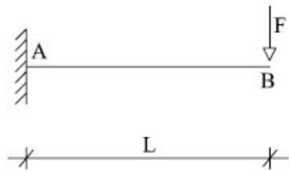
Fase 1: il sistema è isostatico perché G.L.=3 e G.V. (A)=3 e perché il vincolo in A non ha centro di rotazione.
