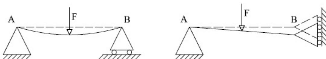
Solo se il sistema è isostatico possiamo calcolare le reazioni vincolari; per farlo occorre sostituire graficamente ai vincoli presenti le reazioni vincolari corrispondenti; la figura seguente mostra quali sono le reazioni equivalenti ad ognuno dei vincoli
