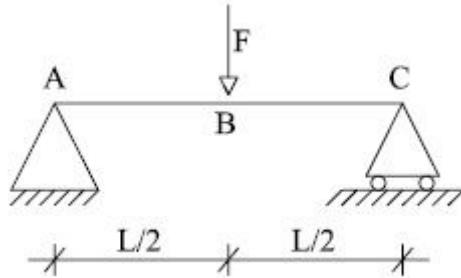
Fase 1: verifichiamo se il sistema è isostatico
